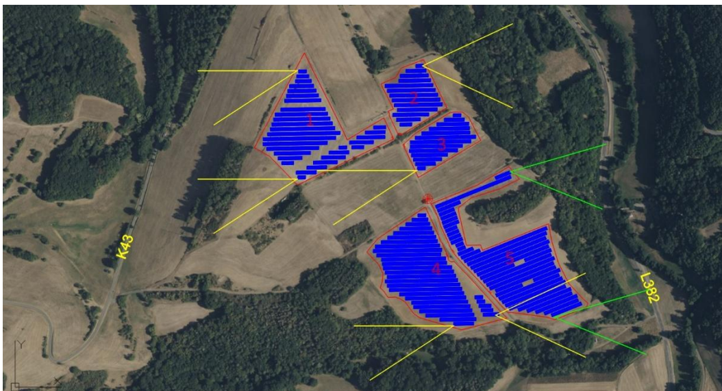
Abbildung 7: Bodennahe Reflexionsrichtungen (gelbe und grüne Winkel) der Belegungsfelder der geplanten PV-Anlage, angezeichnet an ausgewählte Eckpunkte der Felder
