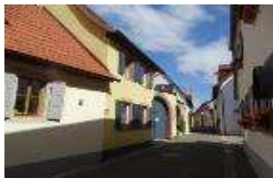
Abbildung 7: Beispiel für eine geschlossene Bauweise
